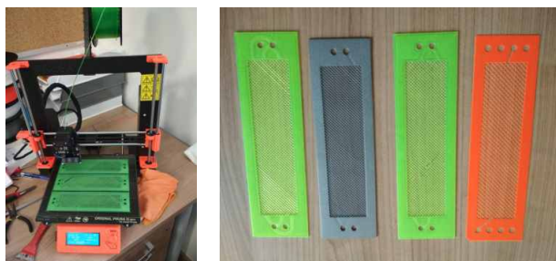
Výroba laboratórnych rozdeľovačov na 3D tlačiarňu a vzorky vyrobených rozdeľovačov
